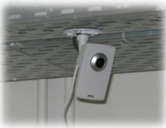
Enfin, un système composé d'un ensemble de caméras détecte et gère les comportements anormaux de la personne dépendante. Il transmet à intervalle régulier des informations sur la position du robot et de la personne dépendante afin d'aider le robot dans sa tâche d'assistance. Ces informations sont principalement utilisées pour la génération de trajectoire du robot.
